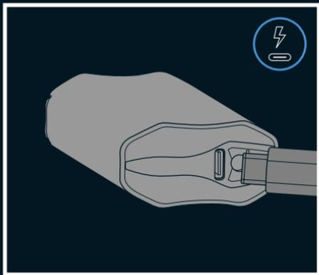
Branchez le **Câble de USB-C** fourni sur un adaptateur de chargement USB dont la puissance ne dépasse pas  $5\text{ V} = 2,5\text{ A}$  et connectez-le au **Port de USB-C**. Lorsque le ZEUS ARC™ a terminé de se recharger, tous les voyants à DEL seront rouge fixe.
