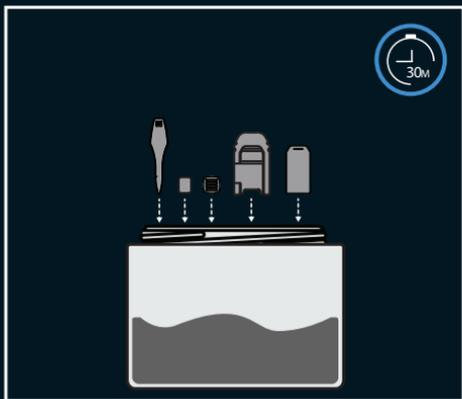
Retirez l'**Outil Multifonction**, le **Flow Sink**, le **Tamis**, l'**Embout GTS** et le **Dissipateur Thermique GTS**. Placez les pièces exposées dans un mélange de ZEUS PURIFY™ ou d'alcool pendant 30 minutes maximum (exception : **Embout GTS**). Par la suite, rincez toutes les pièces à l'eau. Le **Couvercle du Dissipateur Thermique GTS** doit être retiré du **Dissipateur Thermique GTS** avant le rinçage.
