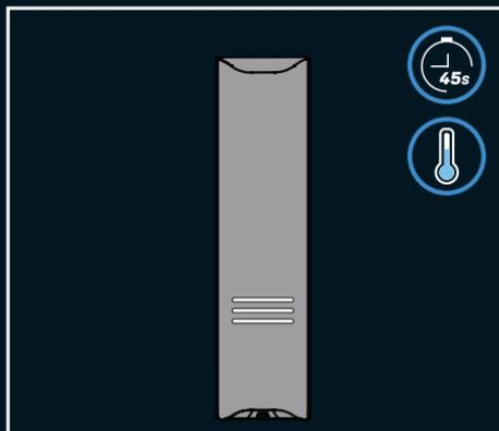
Cuando ZEUS ARC™ no detecta movimiento durante 45 segundos, la función de enfriamiento se activará para ahorrar batería; la **Interfaz de Estado LED** parpadea en blanco para indicar el enfriamiento.
