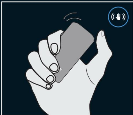
Pour vérifier le niveau de la batterie pendant le fonctionnement, secouez l'appareil deux fois pendant son utilisation. L'**Interface d'État à DEL** affiche le niveau en rouge.
