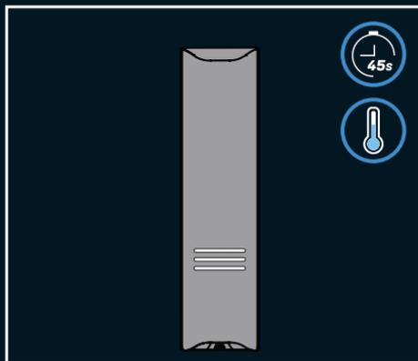
Lorsque ZEUS ARC™ ne détecte aucun mouvement pendant 45 secondes, la fonction de refroidissement s'active pour économiser la batterie ; l'**Interface d'État à DEL** clignote en blanc pour indiquer le refroidissement.
