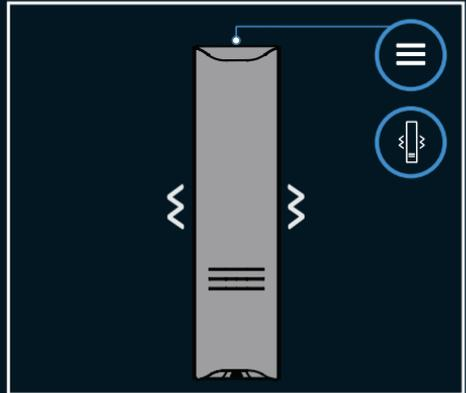
Halten Sie die **Betriebstaste** 2 Sekunden lang gedrückt, um das Gerät ein-/auszuschalten. Ein langes Vibrieren zeigt an, dass das Gerät ein-/ausgeschaltet ist.
