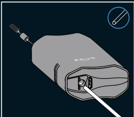
Drücken Sie vorsichtig mit dem **Flow Sink-Werkzeug** von der Unterseite des Luftweges nach oben, um den **Flow Sink** oder den ZEUS ARCPOD™ zu entfernen. Nach der Reinigung die Teile (**Flow Sink & Flow Sink-Sieb**) von oben wieder in die **Heizkammer** einsetzen.
