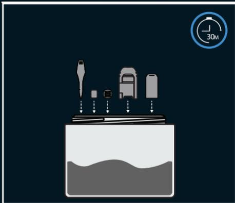
Entfernen Sie das **Multi-Werkzeug**, den **Flow Sink**, das **Sieb**, das **Mundstück GTS** und den **Kühlkörper GTS**. Abgebildete Einzelteile für maximal 30 Minuten in eine Mischung aus ZEUS PURIFY™ oder Alkohol legen (Ausnahme **Mundstück GTS**). Spülen Sie anschließend die Einzelteile mit warmem Wasser ab. Sie sollten vor dem Abspülen die **Kühlkörperabdeckung GTS** vom **Kühlkörper GTS** abnehmen.
