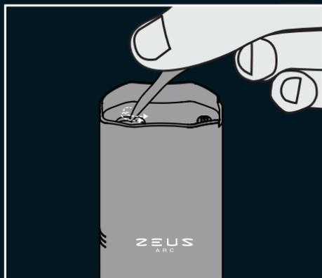
**Multi-Werkzeug** zum Umrühren & Festdrücken des Pflanzenmaterials in der **Heizkammer** und zum Entfernen von verbrauchten ZEUS ARCPODS™ verwenden.
