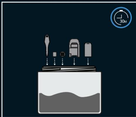
Retire la **Herramienta Multifuncional**, el **Flow Sink**, la **Malla**, la **Boquilla GTS** y el **Disipador de Calor GTS**. Coloque las piezas expuestas en una mezcla de ZEUS PURIFY™ o alcohol durante un máximo de 30 minutos (excepción de la **Boquilla GTS**). Posteriormente, enjuague todas las piezas con agua. La **Tapa del Disipador de Calor GTS** debe retirarse del **Disipador de Calor GTS** antes del enjuague.
