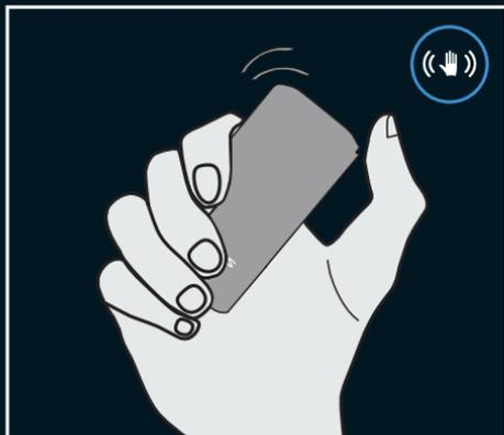
Para comprobar el nivel de la batería durante el funcionamiento, agite el dispositivo dos veces durante su uso. La **Interfaz de Estado LED** se mostrará en rojo.
