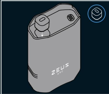
Wenn weniger Kräuter verwendet werden sollen, dann den **Spacer** in die **Heizkammer** einlegen.
